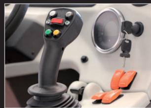
Joystick à 4, 6 et 10 fonctions. Le joystick à 10 fonctions est de série sur LX.
