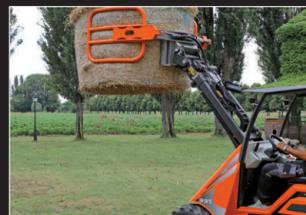
Hauteur du bras télescopique jusqu'à 2980 mm, c'est la plus haute de la catégorie.
